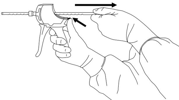
1. Débloquez le piston du distributeur en défaisant le loquet de verrouillage noir et tirez le piston complètement en arrière.
